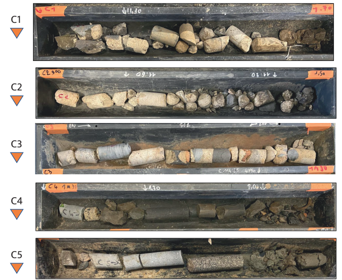
Fig. 49 | Photographie des carottages permettant la reconnaissance des maçonneries et de la profondeur des fondations.
